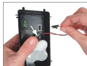
3. Batterie lagerichtig einlegen
