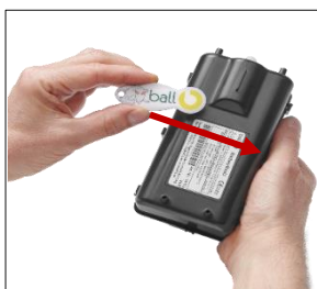
10. BatteryBox U / UEX durch Magnet registrieren
